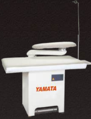
FY TD-B5 Mesa de aquecimento de sucção (ponto em movimento, sem aquecimento elétrico) vacuum ironing table (550W,limit switch, no heating, table size: 650 x1200mm/800x1200mm/800x1500mm)
