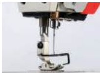
According to the thickness change, the intelligent lifting presser foot De acordo com a mudanca de espessura, o calçador de elevacao inteligente
