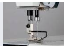
According to the thickness change, the intelligent lifting presser foot De acordo com a mudanca de espessura, o calçador de elevacao inteligente
