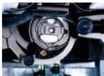
Double round knives cutting mechanism, Effectively reducing process of dealing with the thread head (shorter thread head, less thread piling) Mecanismo de corte de facas redondas duplas, reduzindo efetivamente o processo de lidar com a cabeca da rosca (cabeca de rosca mais curta, menos empilhamento de rosca)
