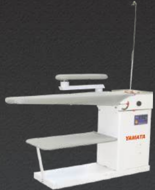
FY TDZ-Q1 Qin tipo sucção quente mesa U shape Vacuum table (550W,table size:390x1200MM)
