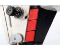
Electronic less nest device/needle stitch compensation, LED lamp, and button reverse sewing combined in one part Dispositivo eletronico menos ninho/compensacao de ponto de agulha, lampada LED e costura reversa de botao combinados em uma parte
